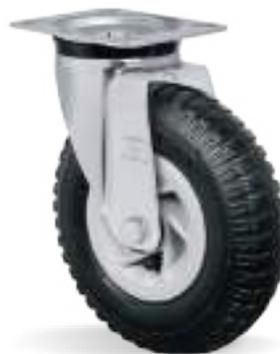
**RUEDA RIT PP - Neumática - Núcleo de Nylon (-20°C hasta +50°C) - Calibrado: 30 lb/pol<sup>2</sup>.** Producidas con neumático y cámara de aire, con núcleo en nylon inyectado. Indicadas para aplicaciones en pisos irregulares donde se requiere la facilidad de desplazamiento y amortiguación de impactos y vibraciones. Permiten fácil mantenimiento y sus componentes pueden ser suministrados en separado. La velocidad máxima de trabajo indicada es 4km/h.
