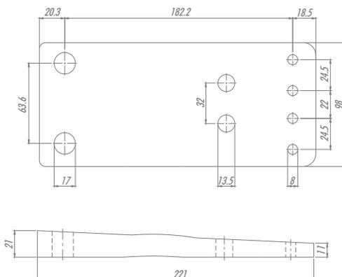
Placa de Elastómero Termoplástico de excelente resistencia mecánica. Utilizada en equipos para depilar cerdos en la industria del ramo alimenticio.
