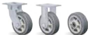
**RUEDA BP - Compuesto Termoplástico. Dureza: 85 Shore A. (-10°C hasta +50°C).** Producidas con revestimiento de compuesto termoplástico con PVC y núcleo de polipropileno copolímero, reciclables. Permiten un rodaje más suave y silencioso, óptima protección al piso, excelente resistencia química, buena resistencia al desgaste e impactos otorgando una óptima relación costo-beneficio. La velocidad máxima de trabajo indicada es 4km/h.
