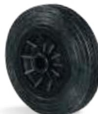
PMN - Neumático Macizo con Núcleo en Polipropileno. Dureza: 80 Shore A. (-20°C hasta +70°C). Fabricadas con aro de goma maciza y núcleo de polipropileno inyectado. Indicadas para uso en pisos irregulares donde es necesaria la facilidad de desplazamiento, amortiguación de impactos y vibraciones. La velocidad máxima de trabajo indicada es 4km/h.
