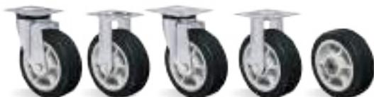
**RUEDA TP - Compuesto Termoplástico.** Dureza: 85 Shore A. (-10°C hasta +50°C). Producidas con revestimiento en compuesto termoplástico y núcleo en polipropileno copolímero reciclables. Ofrecen rodaje suave y silencioso, óptima protección al piso, excelente resistencia química, buena resistencia al desgaste e impactos, resultando en óptima relación costo/beneficio. La velocidad de trabajo indicada es de hasta 4km/h.
