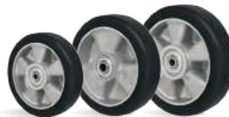
**ALBS - Goma Moldeada con Doble Capa. Dureza: 80 Shore A. (-20°C hasta +70°C).** Producidas con revestimiento de goma moldeada con capa doble vulcanizada en núcleo de aluminio. Proporciona gran absorción de golpes y vibraciones, alta resistencia a la abrasión, y mayor vida útil debido a su capa de goma de mayor espesor. Resistente a la corrosión y a los productos químicos. La velocidad máxima de trabajo indicada es 16km/h.
