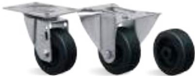
**RUEDA B - Goma Moldeada. Dureza: 80 Shore A. (-20°C hasta +70°C).** Producidas con revestimiento de goma moldeada vulcanizada en núcleo de hierro fundido. Giran con suavidad y bajo nivel de ruido, absorben choques y vibraciones. Son resistentes a la abrasión y a los productos químicos. Pueden ser usadas a una velocidad máxima de 20km/h cuando montadas con rodamientos de bolas y horquillas apropiadas.
