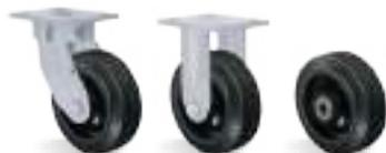
**RUEDA B - Goma Moldeada. Dureza: 80 Shore A. (-20°C hasta +70°C).** Producidas con revestimiento de goma moldeada vulcanizada en núcleo de hierro fundido. Giran con suavidad y bajo nivel de ruido, absorben choques y vibraciones. Son proveídas con grasa cuando montadas con rodamiento de rodillos o bajo solicitud. Resistentes a la abrasión y a los productos químicos. Pueden ser usadas a una velocidad máxima de 20km/h cuando montadas con rodamientos de bolas y horquillas apropiadas.
