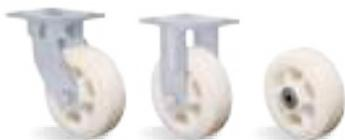
**RUEDA NT - Nylon Técnico. Dureza: 75 Shore D. (-40°C hasta +110°C).** Producidas con revestimiento y núcleo en Poliamida 6 (Nylon) de alta calidad. Son ligeras, tienen óptima resistencia mecánica, giran con mucha facilidad exigiendo menor esfuerzo para maniobras y desplazamientos. Ideales para uso en ambientes húmedos, son resistentes a grasas, aceites, sales y algunos tipos de ácidos. Fabricadas con material reciclable. La velocidad máxima de trabajo indicada es 4km/h.
