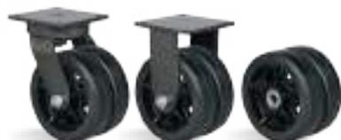
**RUEDA B - Goma Moldeada. Dureza: 80 Shore A. (-20°C hasta +70°C).** Producidas con revestimiento de goma moldeada vulcanizada en núcleo de hierro fundido. Giran con suavidad y bajo nivel de ruido, absorben choques y vibraciones. Son resistentes a la abrasión y a los productos químicos. Pueden ser usadas a una velocidad máxima de 20km/h cuando montadas con rodamientos de bolas y horquillas apropiadas.
