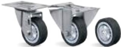
**RUEDA BD - Neumático Macizo con Núcleo en Chapa Estampada. Dureza: 80 Shore A. (-20°C hasta +70°C).** Producidas con aro de goma maciza y núcleo de chapas de acero carbono estampado y acabado zincado. Son ligeras y resistentes, tiene un rodaje suave y silencioso, y son indicadas para servicios livianas en pisos en buen estado. La velocidad máxima de trabajo indicada es de 4km/h.
