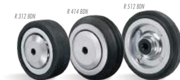
BD - Neumático Macizo con Núcleo en Chapa Estampada. Dureza: 80 Shore A. (-20°C hasta +70°C). Producidas con aro de goma maciza y núcleo de chapas de acero carbono estampado y acabado galvanizado. Son ligeras y resistentes, tiene un rodaje suave y silencioso, y son indicadas para servicios livianas en pisos en buen estado. La velocidad máxima de trabajo indicada es de 4km/h.
