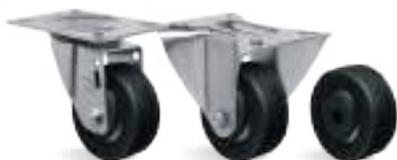
**RUEDA BIN - Goma Moldeada - Núcleo de Ebonite. Dureza: 80 Shore A. (-20°C hasta +70°C).** Producidas con revestimiento de goma moldeada en el núcleo de ebonita. Son ligeras, giran con suavidad y bajo nivel de ruido, absorben choques y vibraciones y no oxidan. Son resistentes a la abrasión ya a los productos químicos. La velocidad máxima de trabajo indicada es 4km/h.
