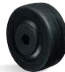
**BIN - Goma Moldeada - Núcleo de Ebonita. Dureza 80 Shore A (-20°C hasta +70°C).** Producidas con revestimiento de goma moldeada en el núcleo de ebonita. Son ligeras, giran con suavidad y bajo nivel de ruido, absorben choques y vibraciones y no oxidan. Son proveídas con grasera cuando montadas con rodamiento de rodillos o bajo solicitud. Resistentes a la abrasión ya a los productos químicos. La velocidad máxima de trabajo indicada es 4km/h.
