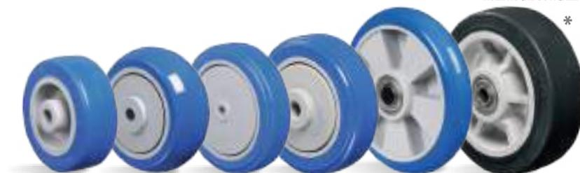
TP - TP - **Compuesto Termoplástico. Dureza: 85 Shore A. (-10°C hasta +50°C).** Producidas con revestimiento en compuesto termoplástico y núcleo en polipropileno copolímero reciclables. Ofrecen rodaje suave y silencioso, óptima protección al piso, excelente resistencia química, buena resistencia al desgaste e impactos, resultando en óptima relación costo/beneficio. La velocidad de trabajo indicada es de hasta 4km/h.
