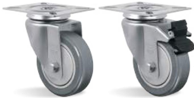
**RUEDA BP - Compuesto Termoplástico con PVC. Dureza: 85 Shore A. (-10°C hasta +50°C).** Producidas con revestimiento de compuesto termoplástico con PVC y núcleo de polipropileno copolímero reciclables. Permiten un rodaje más suave y silencioso, óptima protección al piso, excelente resistencia química, buena resistencia al desgaste e impactos otorgando una óptima relación costo-beneficio. La velocidad máxima de trabajo indicada es 4km/h.
