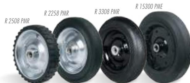
PM - Neumático Macizo con Núcleo en Chapa Estampada. Dureza: 80 Shore A. (-20°C hasta +70°C). Producidas con aro de goma maciza y flanges (núcleo) de chapas de acero carbono estampado. No necesitan mantenimiento, no perforan. Indicadas para pisos irregulares, transponen obstáculos con facilidad. Las flanges son fijadas por tornillos que facilitan el montaje y la reposición de sus componentes, que pueden ser suministrados en separado. La velocidad máxima de trabajo indicada es de 4km/h.
