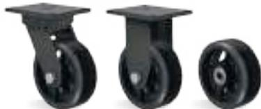
**RUEDA B - Goma Moldeada. Dureza: 80 Shore A. (-20°C hasta +70°C).** Producidas con revestimiento de goma moldeada vulcanizada en núcleo de hierro fundido. Giran con suavidad y bajo nivel de ruido, absorben choques y vibraciones. Son proveídas con grasera cuando montadas con rodamiento de rodillos o bajo solicitud. Resistentes a la abrasión y a los productos químicos. Pueden ser usadas a una velocidad máxima de 20km/h cuando montadas con rodamientos de bolas y horquillas apropiadas.
