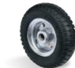
PM - Neumático Macizo con Núcleo en Chapa Estampada. Dureza: 80 Shore A. (-20°C hasta +70°C). Producidas con aro de goma maciza y núcleo de chapas de acero carbono estampado y acabado galvanizado. Son ligeras y resistentes, tiene un rodaje suave y silencioso y son indicadas para servicios livianas en pisos en buen estado. La velocidad máxima de trabajo indicada es de 4km/h.
