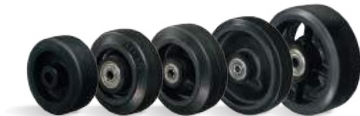
**B - Goma Moldeada. Dureza: 80 Shore A. (-20°C hasta +70°C).** Producidas con revestimiento de goma moldeada vulcanizada en núcleo de hierro fundido. Giran con suavidad y bajo nivel de ruido, absorben choques y vibraciones. Son proveídas con grasea cuando montadas con rodamiento de rodillos o bajo solicitud. Resistentes a la abrasión y a los productos químicos. Pueden ser usadas a una velocidad máxima de 20km/h cuando montadas con rodamientos de bolas y horquillas apropiadas.
