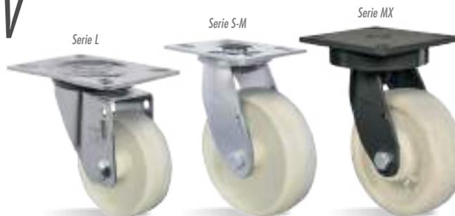
**RUEDA NFV - Nylon Reforzado con Fibra de Vidrio. Dureza: 80 Shore D. (-40°C hasta +180°C).** Producidas com Poliamida 6.6 (Nylon) reforzado con fibra de vidrio. Indicadas para uso en aplicaciones en altas y bajas temperaturas. Son ligeras, tienen óptima resistencia mecánica, giran con mucha facilidad exigiendo menor esfuerzo para maniobras y desplazamientos. Son resistentes a grasas, aceites, sales y algunos tipos de ácidos. La velocidad máxima de trabajo indicada es 4km/h.
