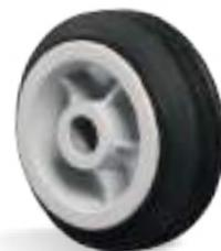
BMN - Neumático Macizo - Núcleo de Nylon. Dureza: 80 Shore A. (-20°C hasta +70°C). Fabricadas con aro de goma maciza y núcleo de nylon inyectado. Es ligeras y resistente, soporta humedad, tiene rodaje suave y silencioso y es indicada para servicios livianos en pisos en buenas condiciones. La velocidad máxima de trabajo indicada es 4km/h.
