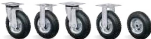
**RUEDA RIT PC - Neumática - Núcleo de Chapa Estampada. (-20°C hasta +50°C) - Calibrado: 30 lb/pol².** Producidas con neumático y cámara de aire, con núcleo en chapa de acero carbono estampado con acabado galvanizado. Indicadas para aplicaciones en pisos irregulares donde se requiere la facilidad de desplazamiento y amortiguación de impactos y vibraciones. Permiten fácil mantenimiento y sus componentes pueden ser suministrados en separado. La velocidad máxima de trabajo indicada es 4km/h.
