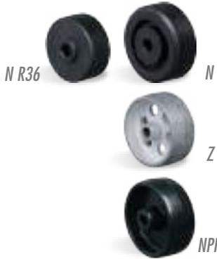
**RUEDA N - Nylon Reforzado con Fibra de Vidrio. Dureza: 80 Shore D. (-40°C hasta +180°C).**
