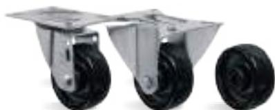
**RUEDA F - Hierro Fundido. Dureza: 160 Brinell. (-40°C hasta +400°C).** Producidas con hierro gris fundido, giran con mucha facilidad y proporcionan una gran reducción del esfuerzo de movimiento. Son muy resistentes y soportan cargas y temperaturas elevadas. No se indican para el uso cuando el nivel de ruido y la conservación del suelo son necesarios. La velocidad máxima de trabajo indicada es 4km/h.
