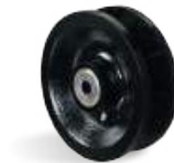
V - Grooved - Hierro con Canal en V. Dureza: 160 Brinell. (-40°C hasta +400°C). Producidas con hierro gris fundido, poseen canal en “V” en la banda de rodaje. Diseñadas para montaje sobre las cantoneras, giran con facilidad y proporcionan una gran reducción del esfuerzo de movimiento. Son muy resistentes y soportan cargas y temperaturas elevadas.
