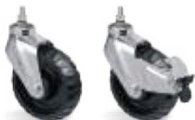
**RUEDA STR - Goma Termoplástica. Dureza: 70 Shore A. (-20°C hasta +70°C).** Producida con revestimiento en goma termoplástica y núcleo en polipropileno copolímero reciclables. El perfil de la banda de rodaje posee diseños en forma de estrías que permite mayor adherencia en pisos internos y externos. Proporciona rodamiento suave y silencioso. Excelente protección al piso, resistencia química, resistencia al desgaste e impactos. La velocidad de trabajo indicada es de hasta 4 km/h.
