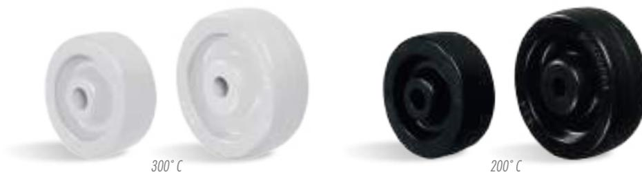
TM - Termic. Dureza: 90 Shore D. Negro (0°C hasta +200°C), Gris (0°C hasta +300°C). Fabricadas con resina fenólica (baquelita), moldeadas bajo alta presión y calor. Indicadas para uso en ambientes con altas temperaturas. Tienen buenas propiedades mecánicas, no deforman con carga estática, y giran con facilidad. Son resistentes a la mayoría de los productos químicos. La velocidad máxima de trabajo indicada es 4km/h.
