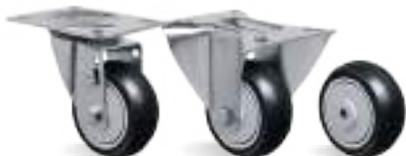
**RUEDA NP - Polipropileno. Dureza: 65 Shore D. (-20°C hasta +70°C).** Inyectadas con revestimiento y núcleo en polipropileno copolímero reciclable. Indicada para cargas livianas y medianas, giran con mucha facilidad, requiriendo poco esfuerzo para el desplazamiento, no deforman bajo carga estática y tienen óptima relación costo/beneficio. Presentan buena resistencia química y a impactos moderados. La velocidad máxima de trabajo indicada es 4km/h.
