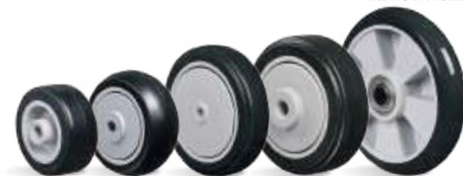
NP - Polipropileno. Dureza: 65 Shore D. (-20°C hasta +70°C). Inyectadas con revestimiento y núcleo en polipropileno copolímero, reciclables. Indicada para cargas livianas y medianas, giran con mucha facilidad, requiriendo poco esfuerzo para el desplazamiento, no deforman bajo carga estática y tienen óptima relación costo/beneficio. Presentan buena resistencia química y a impactos moderados. La velocidad máxima de trabajo indicada es 4km/h.
