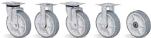
**RUEDA BP - Compuesto Termoplástico. Dureza: 85 Shore A. (-10°C hasta +50°C).** Producidas con revestimiento de compuesto termoplástico con PVC y núcleo de polipropileno copolímero, reciclables. Permiten un rodaje más suave y silencioso, óptima protección al piso, excelente resistencia química, buena resistencia al desgaste e impactos otorgando una óptima relación costo-beneficio. La velocidad máxima de trabajo indicada es 4km/h.
