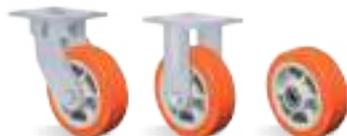
**RUEDA UP - Poliuretano Termoplástico. Dureza: 90 Shore A. (-20°C hasta +70°C).** Producidas con revestimiento en poliuretano termoplástico elastollan y núcleo en polipropileno copolímero reciclable. Ideales para quién busca excelente capacidad de carga y también una óptima protección al piso y bajo ruido en el desplazamiento, proporcionan excelente resistencia a la abrasión e impactos. Resistentes a grasas, aceites minerales y algunos ácidos. La velocidad máxima de trabajo indicada es 4km/h.
