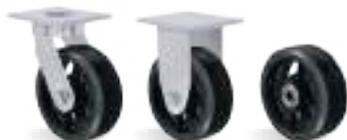
**RUEDA B - Goma Moldeada. Dureza: 80 Shore A. (-20°C hasta +70°C).** Producidas con revestimiento de goma moldeada vulcanizada en núcleo de hierro fundido. Giran con suavidad y bajo nivel de ruido, absorben choques y vibraciones. Son proveídas con grasa cuando montadas con rodamiento de rodillos o bajo solicitud. Pueden ser usadas a una velocidad máxima de 20km/h cuando montadas con rodamientos de bolas y horquillas apropiadas.
