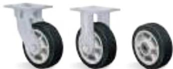
**RUEDA TP - Compuesto Termoplástico. Dureza: 85 Shore A. (-10°C hasta +50°C).** Producidas con revestimiento en compuesto termoplástico y núcleo en polipropileno copolímero reciclables. Ofrecen rodaje suave y silencioso, óptima protección al piso, excelente resistencia química, buena resistencia al desgaste e impactos, resultando en óptima relación costo/beneficio. La velocidad de trabajo indicada es de hasta 4 km/h.
