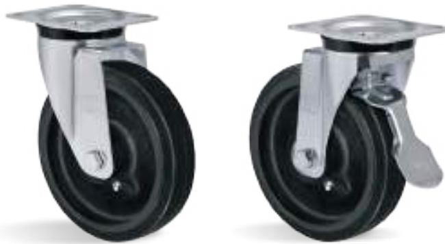
**RUEDA B - Goma Moldeada. Dureza: 80 Shore A. (-20°C hasta +70°C).** Producidas con revestimiento de goma moldeada vulcanizada en núcleo de hierro fundido. Giran con suavidad y bajo nivel de ruido, absorben choques y vibraciones. Son proveídas con graseira cuando montadas con rodamiento de rodillos o bajo solicitud. Resistentes a la abrasión y a los productos químicos. Pueden ser usadas a una velocidad máxima de 20km/h cuando montadas con rodamientos de bolas y horquillas apropiadas.
