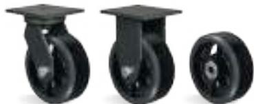
**RUEDA B - Goma Moldeada. Dureza: 80 Shore A. (-20°C hasta +70°C).** Producidas con revestimiento de goma moldeada vulcanizada en núcleo de hierro fundido. Giran con suavidad y bajo nivel de ruido, absorben choques y vibraciones. Son proveídas con grasera cuando montadas con rodamiento de rodillos o bajo solicitud. Resistentes a la abrasión y a los productos químicos. Pueden ser usadas a una velocidad máxima de 20km/h cuando montadas con rodamientos de bolas y horquillas apropiadas.
