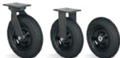
**RUEDA PC - Neumática - Núcleo de Chapa Estampada (-20°C hasta +50°C).** Producidas con neumático y cámara de aire, con núcleo en chapa de acero carbono estampado con acabado pintado. Indicadas para aplicaciones en pisos irregulares donde se requiere la facilidad de desplazamiento y amortiguación de impactos y vibraciones. Permiten fácil mantenimiento y sus componentes pueden ser suministrados en separado. La velocidad máxima de trabajo indicada es 4km/h.
