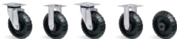
**RUEDA STR - Goma Termoplástica.** Dureza: 70 Shore A. (-20°C hasta +70°C). Producida con revestimiento en goma termoplástica y núcleo en polipropileno copolímero reciclables. El perfil de la banda de rodaje posee diseños en forma de estrías que permite mayor adherencia en pisos internos y externos. Proporciona rodamiento suave y silencioso. Excelente protección al piso, resistencia química, resistencia al desgaste e impactos. La velocidad de trabajo indicada es de hasta 4km/h.
