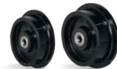
DV - Decauville - Hierro para Carril. Dureza: 160 Brinell. (-40°C hasta +400°C). Producidas con hierro gris fundido, posee una pestaña en el lateral de la banda de rodamiento. Diseñadas para montajes sobre rieles o vigas. Giran con mucha facilidad y proporcionan una gran reducción del esfuerzo de movimiento. Son muy resistentes y soportan cargas y temperaturas elevadas.
