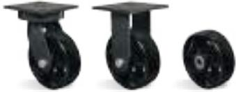
**RUEDA F - Hierro Fundido. Dureza: 160 Brinell. (-40°C hasta +400°C).** Producidas con hierro gris fundido, giran con mucha facilidad y proporcionan una gran reducción del esfuerzo de movimiento. Son muy resistentes y soportan cargas y temperaturas elevadas. No se indican para el uso cuando el nivel de ruido y la conservación del suelo son necesarios. La velocidad máxima de trabajo indicada es 4km/h.
