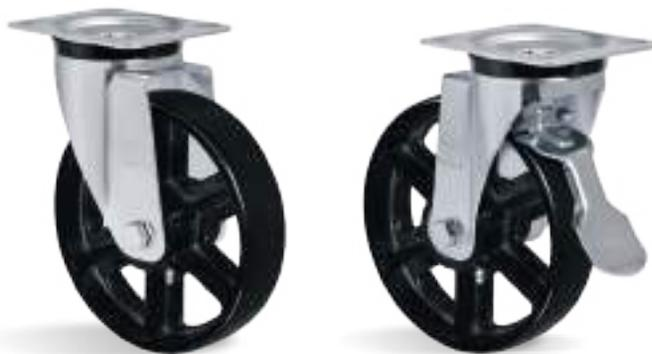
**RUEDA F - Hierro Fundido. Dureza: 160 Brinell. (-40°C hasta +400°C).** Producidas con hierro gris fundido, giran con mucha facilidad y proporcionan una gran reducción del esfuerzo de movimiento. Son muy resistentes y soportan cargas y temperaturas elevadas. No se indican para el uso cuando el nivel de ruido y la conservación del suelo son necesarios. La velocidad máxima de trabajo indicada es 4km/h.
