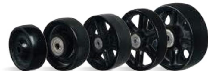
**F - Hierro Fundido. Dureza: 160 Brinell. (-40°C hasta +400°C).** Producidas con hierro gris fundido, giran con mucha facilidad y proporcionan una gran reducción del esfuerzo de movimiento. Son muy resistentes y soportan cargas y temperaturas elevadas. No se indican para el uso cuando el nivel de ruido y la conservación del suelo son necesarios. La velocidad máxima de trabajo indicada es 4km/h.
