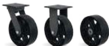
**RUEDA F - Hierro Fundido. Dureza: 160 Brinell. (-40°C hasta +400°C).** Producidas con hierro gris fundido, giran con mucha facilidad y proporcionan una gran reducción del esfuerzo de movimiento. Son muy resistentes y soportan cargas y temperaturas elevadas. No se indican para el uso cuando el nivel de ruido y la conservación del suelo son necesarios. La velocidad máxima de trabajo indicada es 4km/h.
