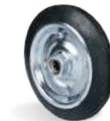
PM - Neumático Macizo con Núcleo en Chapa Estampada. Dureza: 80 Shore A. (-20°C hasta +70°C). Producidas con aro de goma maciza y núcleo de chapas de acero carbono estampado y acabado galvanizado. Son ligeras y resistentes, tiene un rodaje suave y silencioso, y son indicadas para servicios livianas en pisos en buen estado. La velocidad máxima de trabajo indicada es de 4km/h.
