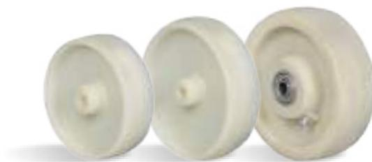
NFV - Nylon Reforzado con Fibra de Vidrio. Dureza: 80 Shore D. (-40°C hasta +180°C). Producidas con Poliamida 6.6 (Nylon) reforzado con fibra de vidrio. Indicadas para uso en aplicaciones en altas y bajas temperaturas. Son ligeras, tienen óptima resistencia mecánica, giran con mucha facilidad exigiendo menor esfuerzo para maniobras y desplazamientos. Son resistentes a grasas, aceites, sales y algunos tipos de ácidos. La velocidad máxima de trabajo indicada es 4km/h.
