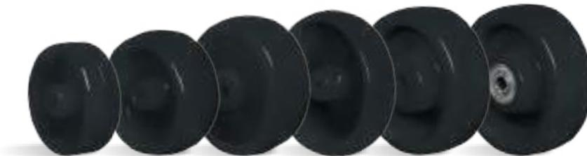
**NPP - Polipropileno. Dureza: 65 Shore D. (-20°C hasta +70°C).** Producidas en inyección única con polipropileno copolímero reciclable. Indicadas para cargas livianas, giran con mucha facilidad, requiriendo poco esfuerzo para el desplazamiento, no deforman bajo carga estática y tienen óptima relación costo/beneficio. Presentan buena resistencia química y a impactos moderados. La velocidad máxima de trabajo indicada es 4km/h.
