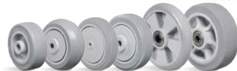
SP - Goma Termoplástica Extra Blanda. Dureza: 65 Shore A. (-10°C hasta +50°C). Ruedas inyectadas con revestimiento de goma termoplástica extra blanda y núcleo de polipropileno copolímero, reciclables. Sus ventajas son el bajo nivel de ruido en el desplazamiento y la reducción de vibraciones. Indicadas para desplazar cargas livianas, ofrecen excelente protección al piso, resistencia regular a impactos y buena resistencia a medios químicos. La velocidad máxima de trabajo indicada es 4km/h.
