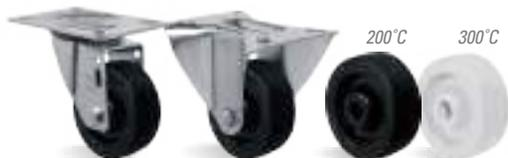
**RUEDA TM - Termic. Dureza: 90 Shore D. Preta (0°C hasta +200°C), Cinza (0°C hasta +300°C).** Fabricadas con resina fen6lica (baquelita), moldeadas bajo alta presi6n y calor. Indicadas para uso en ambientes con altas temperaturas. Tienen buenas propiedades mec6nicas, no deforman con carga est6tica, y giran con facilidad. Son resistentes a la mayoria de los productos qu6micos. La velocidad m6xima de trabajo indicada es 4km/h.
