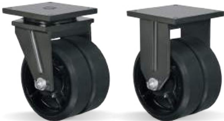
**RUEDA B - Goma Moldeada. Dureza: 80 Shore A. (-20°C hasta +70°C).** Producidas con revestimiento de goma moldeada vulcanizada en núcleo de hierro fundido. Giran con suavidad y bajo nivel de ruido, absorben choques y vibraciones. Son resistentes a la abrasión y a los productos químicos. Pueden ser usadas a una velocidad máxima de 20km/h cuando montadas con rodamientos de bolas y horquillas apropiadas.
