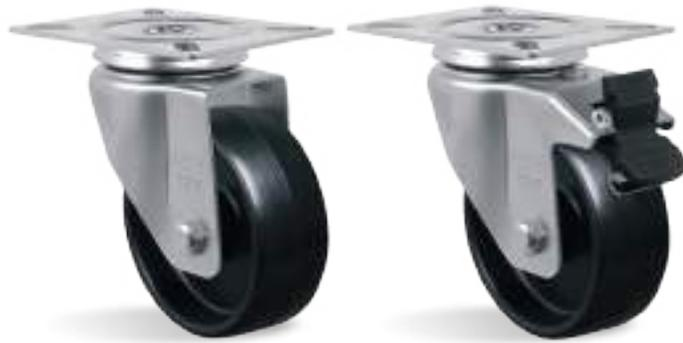
**RUEDA NPP - Polipropileno. Dureza: 65 Shore D. (-20°C hasta +70°C).** Producidas en inyección única con polipropileno copolímero reciclable. Indicadas para cargas livianas, giran con mucha facilidad, requiriendo poco esfuerzo para el desplazamiento, no deforman bajo carga estática y tienen óptima relación costo/beneficio. Presentan buena resistencia química y a impactos moderados. La velocidad máxima de trabajo indicada es 4km/h.
