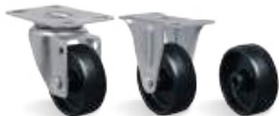
**RUEDA NPP - Polipropileno. Dureza: 65 Shore D. (-20°C hasta +70°C).** Producidas en inyección única con polipropileno copolímero reciclable. Indicadas para cargas livianas, giran con mucha facilidad, requiriendo poco esfuerzo para el desplazamiento, no deforman bajo carga estática y tienen óptima relación costo/beneficio. Presentan buena resistencia química y a impactos moderados. La velocidad máxima de trabajo indicada es 4km/h.
