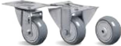
**RUEDA BP - Compuesto Termoplástico con PVC. Dureza: 85 Shore A. (-10°C hasta +50°C).** Producidas con revestimiento de compuesto termoplástico con PVC y núcleo de polipropileno copolímero reciclables. Permiten un rodaje más suave y silencioso, óptima protección al piso, excelente resistencia química, buena resistencia al desgaste e impactos otorgando una óptima relación costo-beneficio. La velocidad máxima de trabajo indicada es 4km/h.
