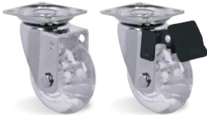
**RUEDA COLORGEL** – Compuesto termoplástico con PVC transparente. Dureza: 90 Shore A. (-10°C hasta +50°C)
