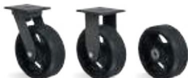
**RUEDA B - Goma Moldeada.** Dureza: 80 Shore A. (-20°C hasta +70°C). Producidas con revestimiento de goma moldeada vulcanizada en núcleo de hierro fundido. Giran con suavidad y bajo nivel de ruido, absorben choques y vibraciones. Son resistentes a la abrasión y a los productos químicos. Pueden ser usadas a una velocidad máxima de 20km/h cuando montadas con rodamientos de bolas y horquillas apropiadas.
