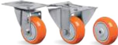
**RUEDA UP - Poliuretano Termoplástico. Dureza: 90 Shore A. (-20°C hasta +70°C).** Inyectadas con revestimiento y núcleo en polipropileno copolímero reciclable. Indicada para cargas livianas y medianas, giran con mucha facilidad, requiriendo poco esfuerzo para el desplazamiento, no deforman bajo carga estática y tienen óptima relación costo/beneficio. Presentan buena resistencia química y a impactos moderados. La velocidad máxima de trabajo indicada es 4km/h.
